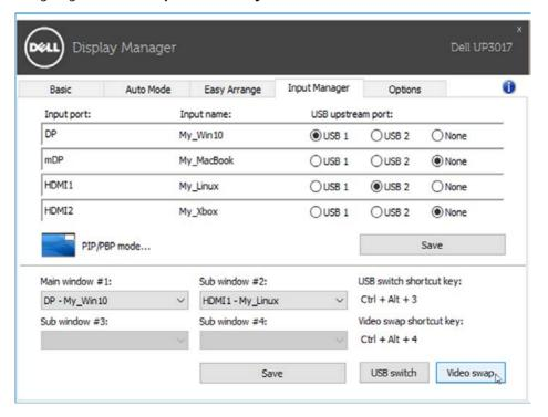
Sie können Ihrem Videoeingang einen USB-Upstream-Port zuweisen. Der zugewiesene USB-Upstream-Port wird mit dem Computer verbunden, wenn sein Video am Monitor angezeigt wird.
