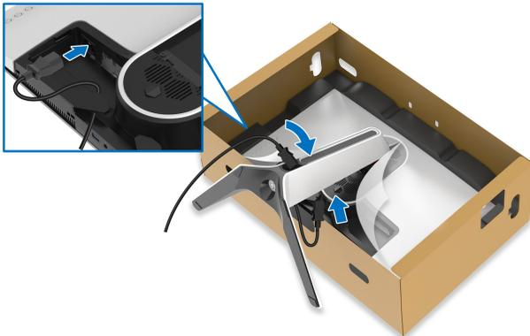
9. Verlegen Sie nun die benötigten Kabel durch den Kabelführungsschlitz am Ständer und dann durch die Kabelführungsklemme an der Rückseite des Monitors.
