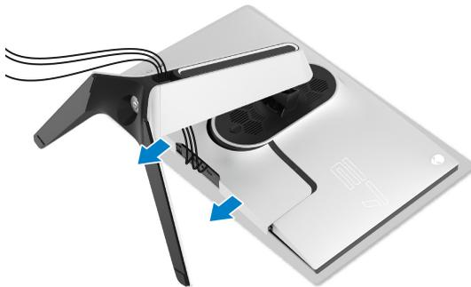
5. Trennen Sie die Kabel vom Monitor und schieben Sie sie durch die Kabelführungsöffnung am Ständer.
