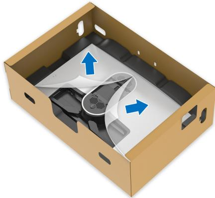
6. Fügen Sie die Laschen am Ständer vorsichtig in die Schlitzte an der hinteren Abdeckung des Monitors ein und senken Sie den Ständer ab, um ihn einrasten zu lassen.
