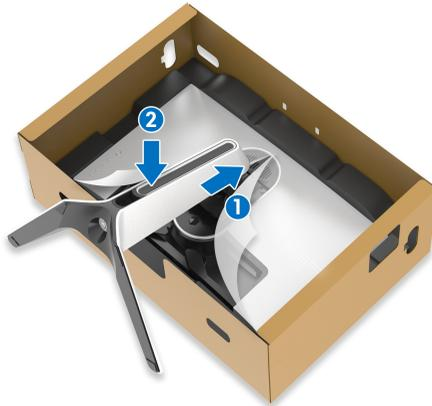
7. Verlegen Sie das Netzkabel durch den Kabelführungsschlitz am Ständer und durch den Kabelführungsklemme an der Rückseite des Monitors.
