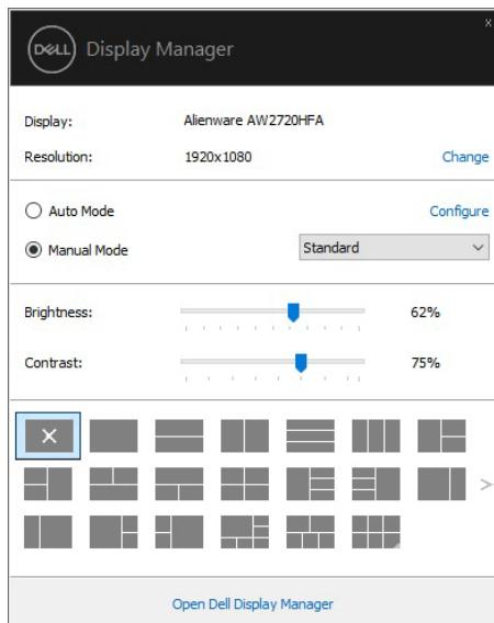
La boîte de dialogue **Réglages rapides** permet également d'accéder à l'interface utilisateur avancée de Dell Display Manager qui est utilisée pour ajuster les fonctions de base, configurer le Mode auto et accéder aux autres fonctions.
