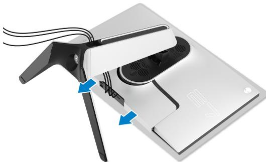
5. Déconnectez les câbles du moniteur et faites les sortir à travers l'orifice de rangement des câbles sur la colonne du pied.
