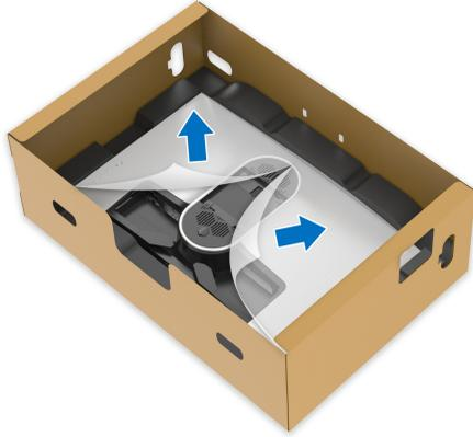
6. Insérez avec précaution les onglets de la colonne du pied dans les fentes du capot arrière de l'écran et abaissez l'ensemble du pied pour l'enclencher en place.
