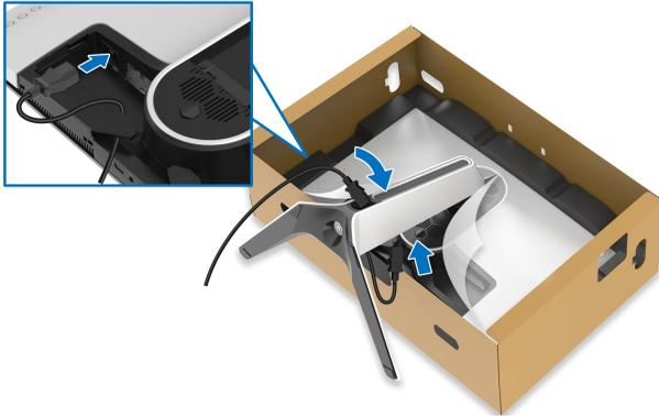
9. Maintenant, faites passer les câbles nécessaires dans le connecteur de gestion des câbles sur le pied et dans le clip de gestion des câbles à l'arrière de l'écran.
