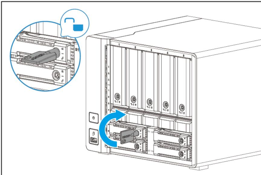
3. Entfernen Sie den Laufwerkseinsatz.
