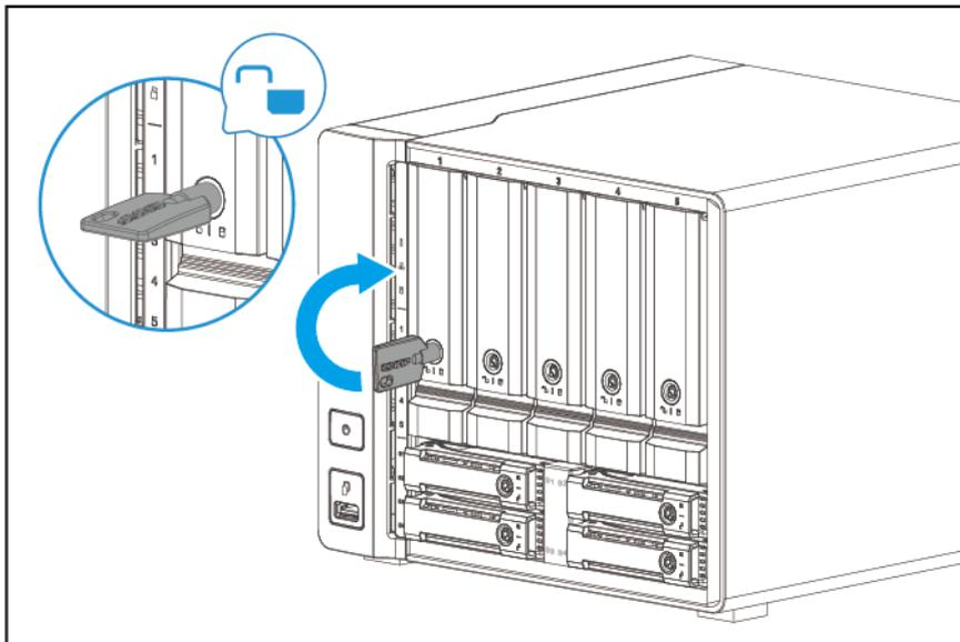
3. Entfernen Sie den Laufwerkseinsatz.
