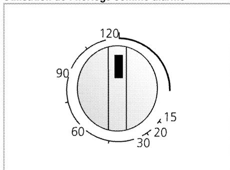
L'alarme n'a aucune influence sur les fonctions du four. Elle sert uniquement d'avertissement. Cela peut être utile, par exemple, lorsque vous voulez retourner les aliments dans le four après un certain temps. L'alarme émettra un signal une fois l'heure réglée achevée.
