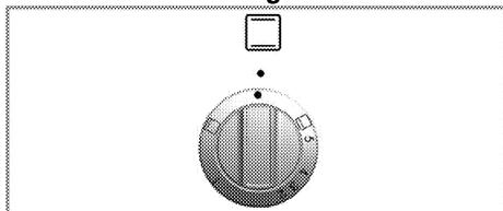
Le four à gaz est actionné par la manette de commande du four à gaz. Dans la position arrêt (haut) l'alimentation en gaz est coupée.
