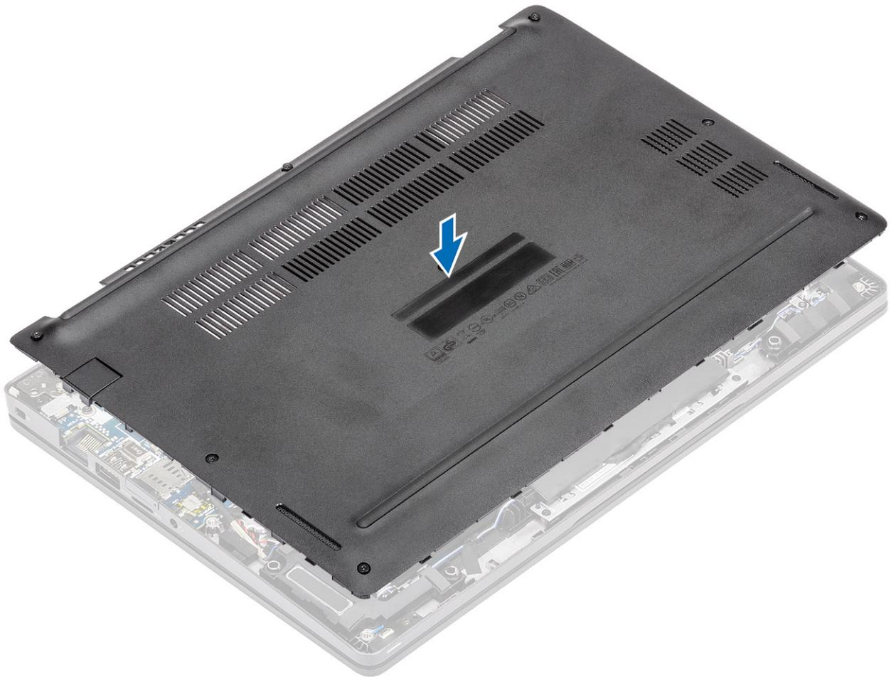
3. Presione los bordes y los laterales de la cubierta de la base hasta que encaje en su lugar.
