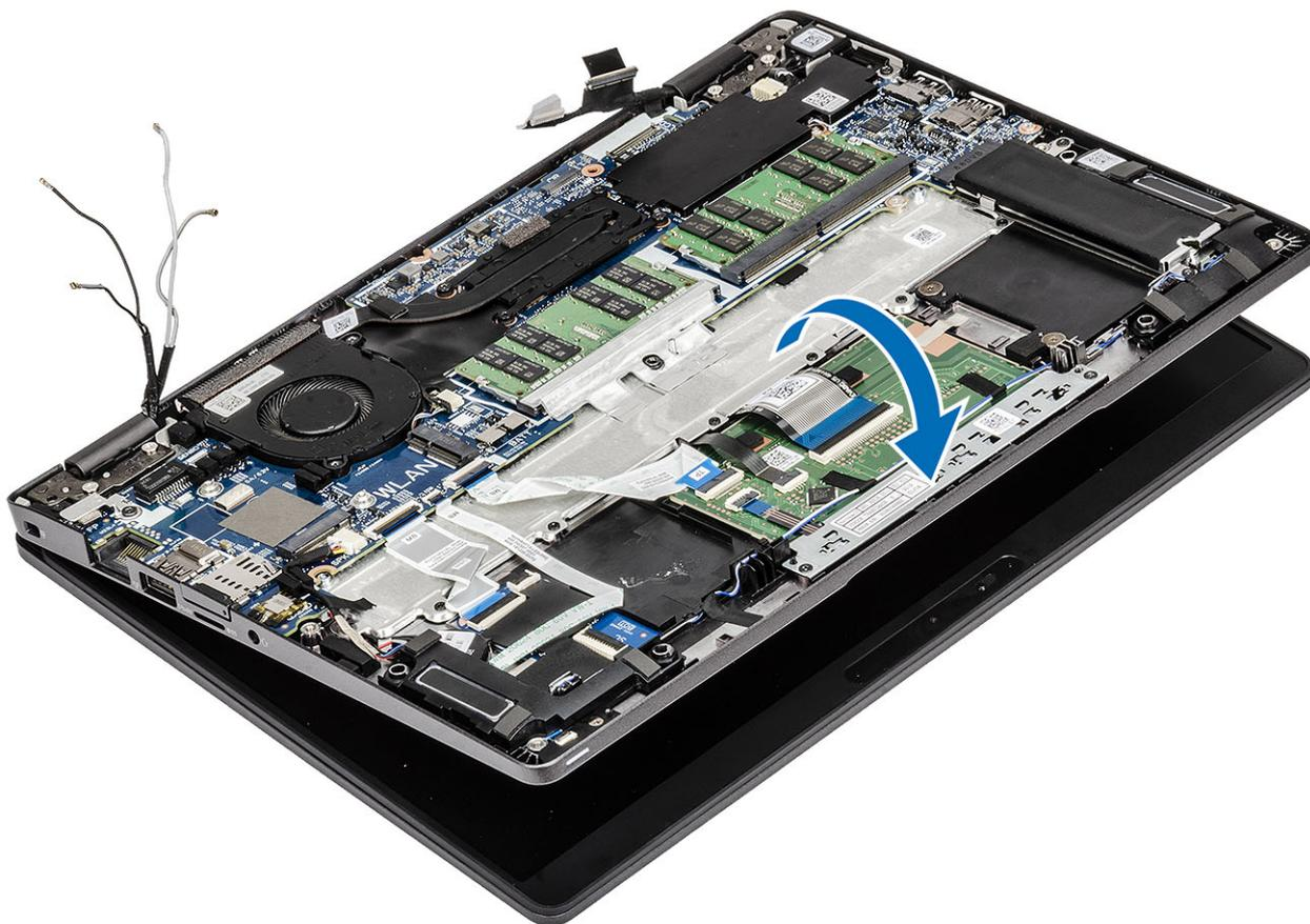
4. Conecte el cable al conector de la tarjeta madre del sistema y adhiera la cinta adhesiva [1].
