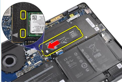
Reemplace la placa térmica de la SSD en la parte superior de la SSD y asegúrela con el tornillo único M2x2 a la tarjeta madre.
