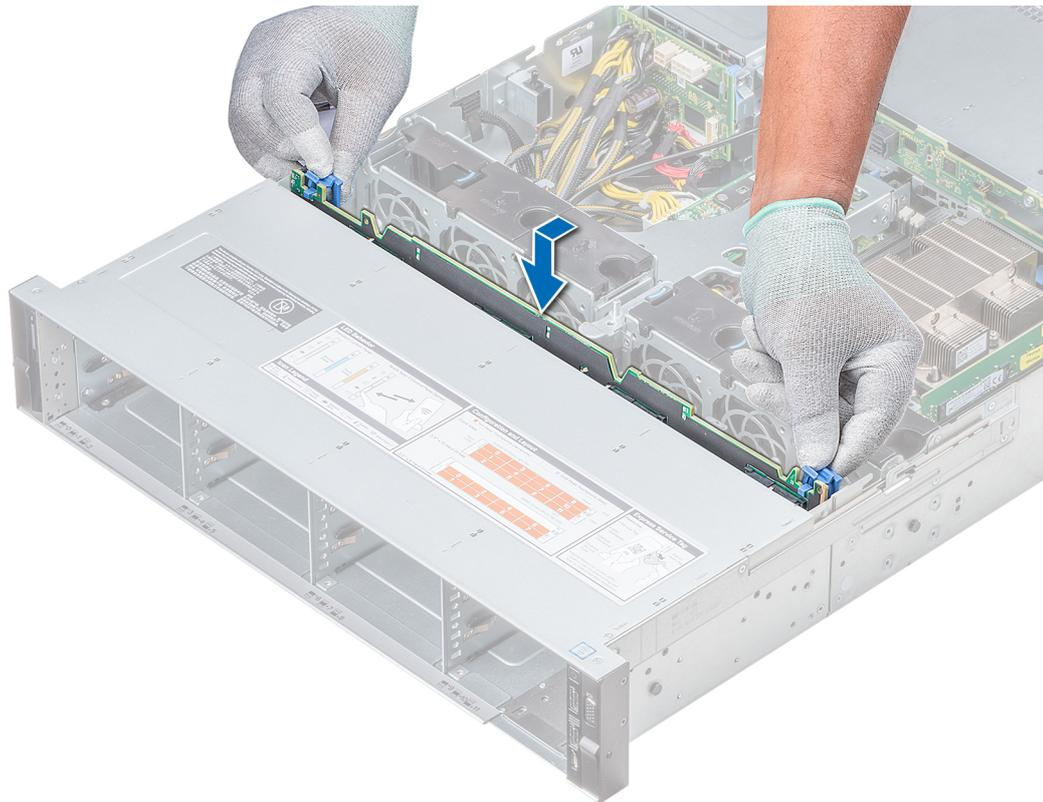
**Ilustración 102. Instalación del plano posterior**
