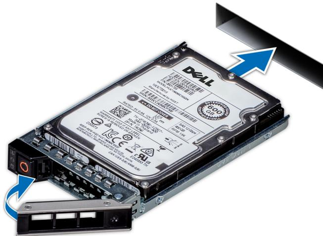
**Ilustración 52. Instalación de un portaunidades**
