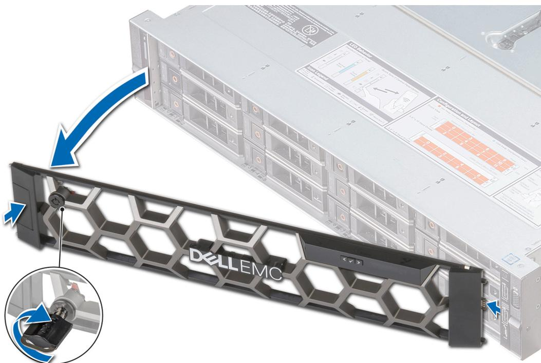
**Ilustración 23.** Extracción de la cubierta frontal con el panel LCD
