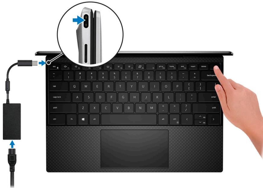
**NOTA:** La batería puede entrar en modo de ahorro de energía durante el envío para conservar la carga. Asegúrese de que el adaptador de alimentación esté conectado a la computadora cuando se enciende por primera vez.
