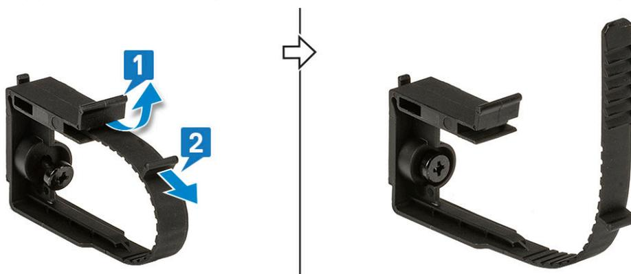
5. Alinhe o trinco de libertação do cabo na ranhura do chassis do sistema [1]. Aperte o parafuso para fixar o trinco de libertação do cabo ao chassis do sistema [2].
