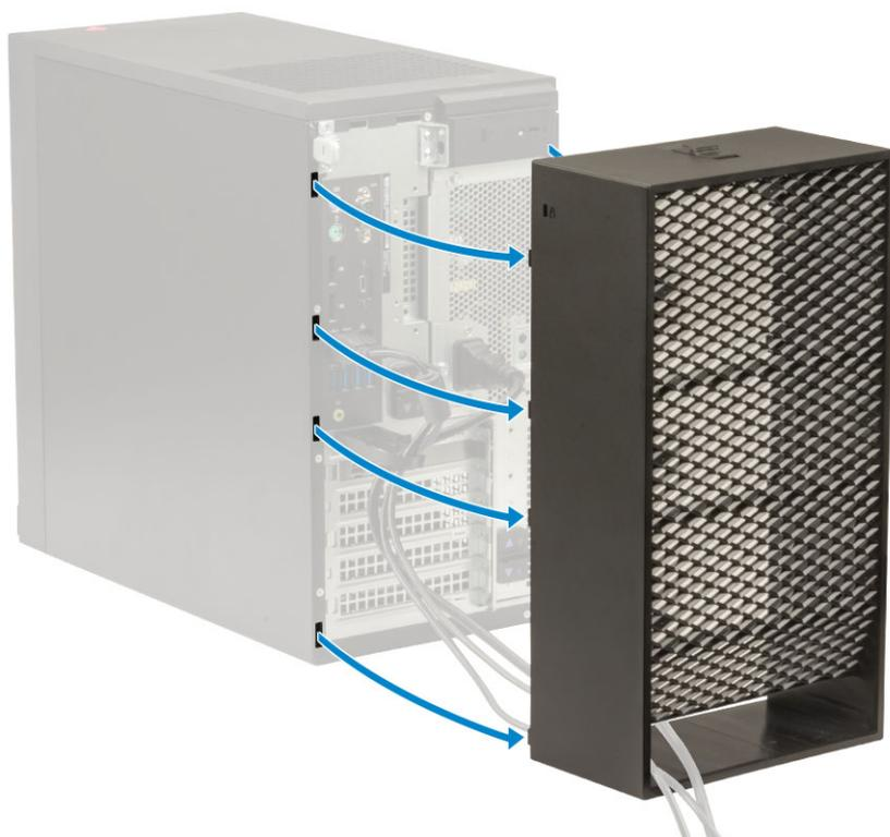
11. Abra a patilha e desencaminhe os cabos da braçadeira [1] e desligue os cabos das portas no sistema [2]. Retire os cabos da ranhura da cobertura do cabo [3].
