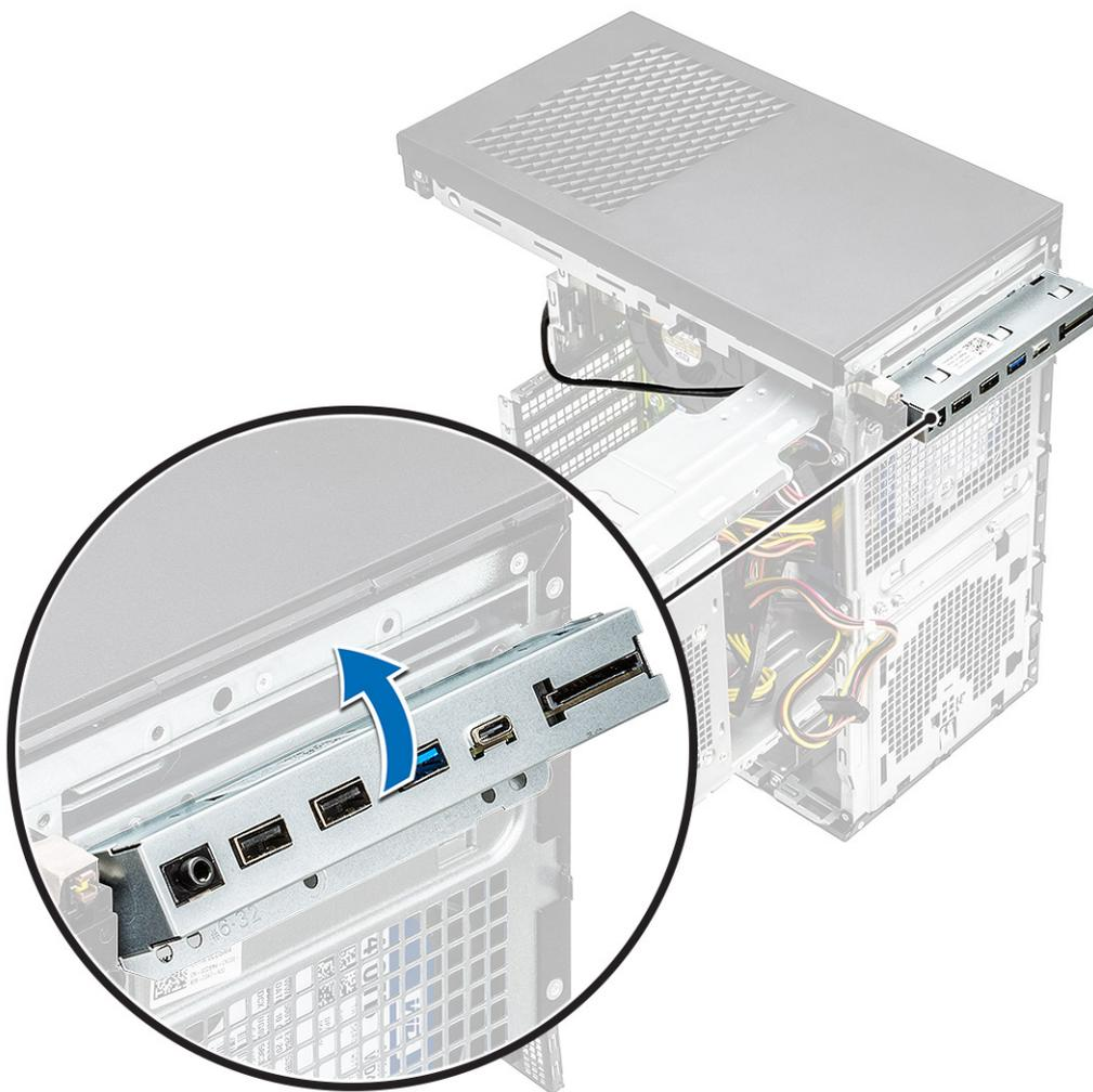
8. Puxe o painel E/S juntamente com os cabos para o remover da ranhura do painel E/S no chassis.
