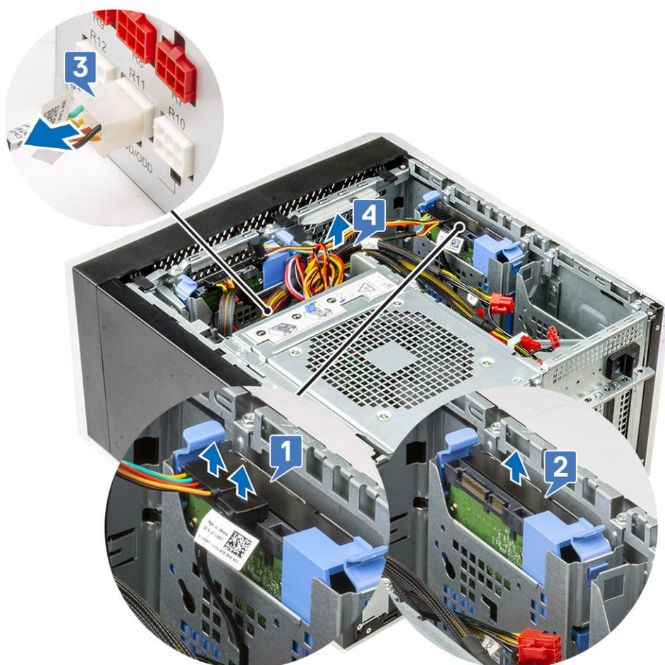
8. Flexione o suporte do disco rígido [1], levante o disco [2] e, em seguida, deslize-o para fora do suporte [3].
