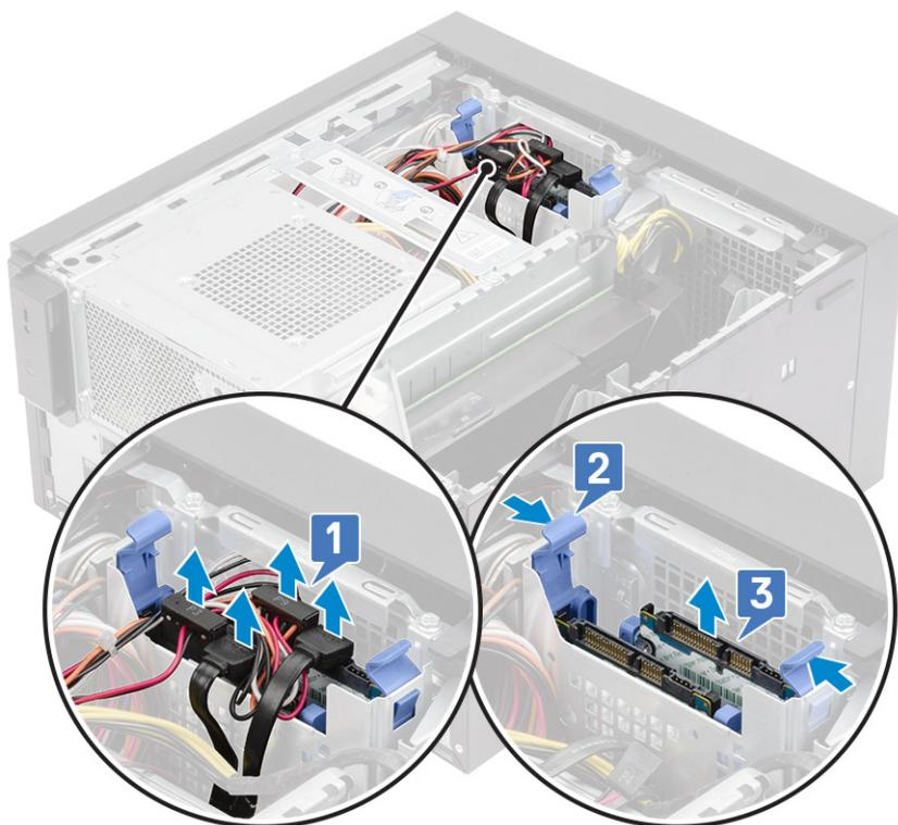
5. Desligue os cabos de dados e os cabos de alimentação dos respectivos conectores no disco rígido [1].
