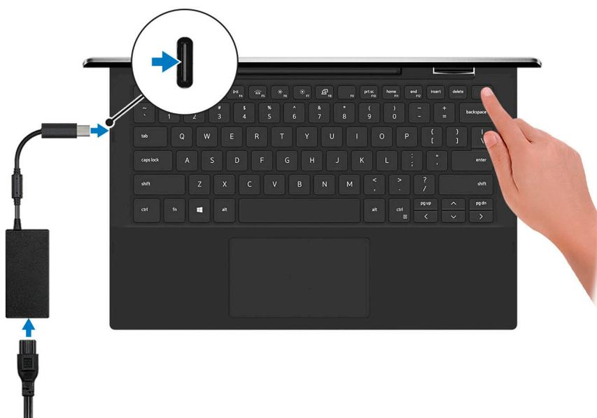
**i** **N.B.:** La batteria può entrare in modalità di risparmio energetico durante la spedizione per conservare la carica. Accertarsi che l'adattatore di alimentazione sia collegato al computer quando viene acceso per la prima volta.
