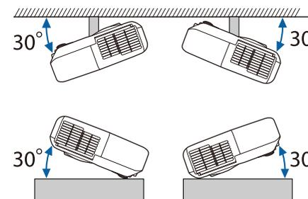
L'utilizzo del proiettore con un angolo di inclinazione superiore ai 30° potrebbe causare danni e incidenti.
