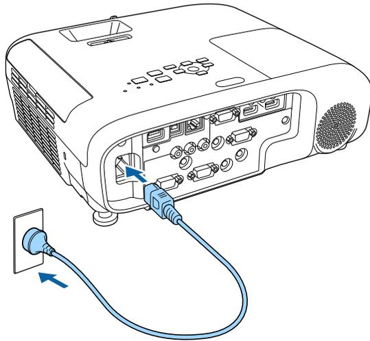
L'indicatore del proiettore si illumina di blu. Indica che il proiettore riceve alimentazione, ma non è ancora acceso (è in modalità stand by).
