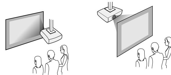
Accertarsi di selezionare l'opzione **Proiezione** corretta nel menu **Avanzate** del proiettore a seconda del metodo di installazione in uso.
