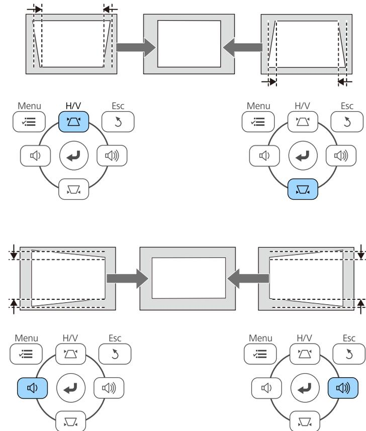
• Se il proiettore è installato in una posizione difficile da raggiungere, è inoltre possibile correggere la forma dell'immagine tramite telecomando.
