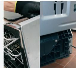
2. Utilizzando il cacciavite T15, rimuovere le viti che tengono fissata il coperchio dell'elettrodomestico
