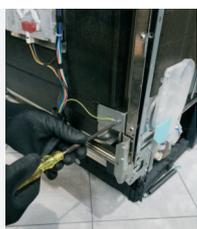
12. Fissare la vite frontale della cerniera
