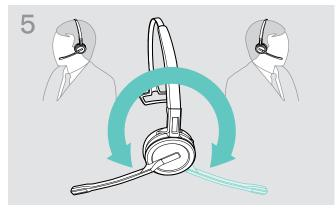
Ruotare il braccio del microfono per modificare il lato di utilizzo.
