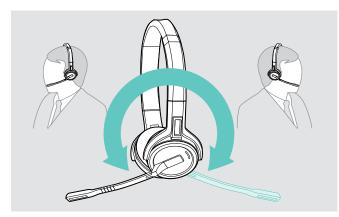
> Ruotare il braccio del microfono per modificare il lato di
