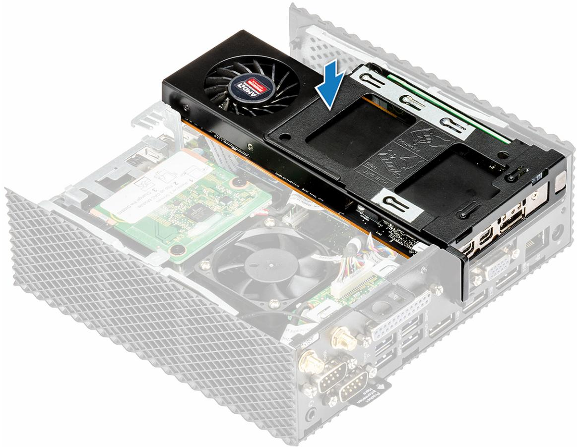
**Figure 16. Appuyer sur le module PCIe**
