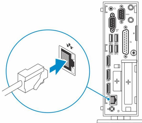
**Figure 4. Connecter le câble réseau**
