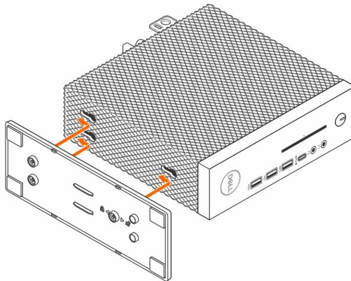
**Figure 2. Installer le socle**
