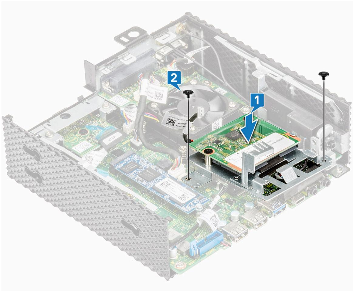
**Figure 20. Aligner les trous de vis et remettre les vis en place**
