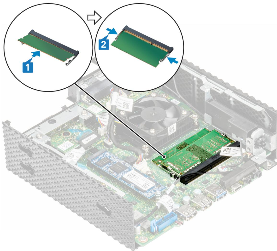
**Figure 24. Installer un module mémoire**
