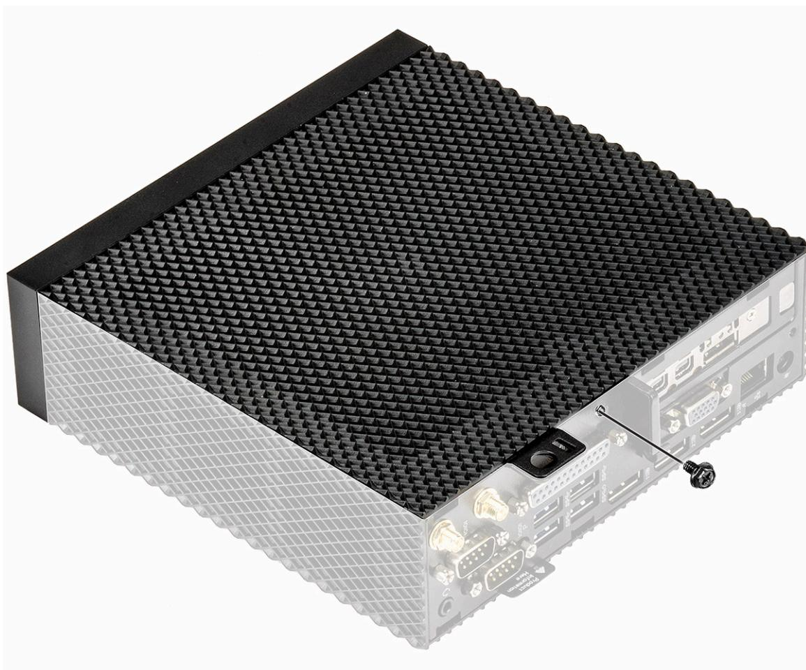
**Figure 7. Desserrage de la vis moletée**
