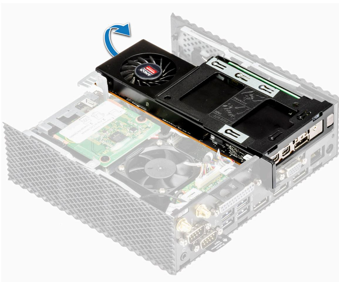
Figure 13. Retrait du module PCIe
