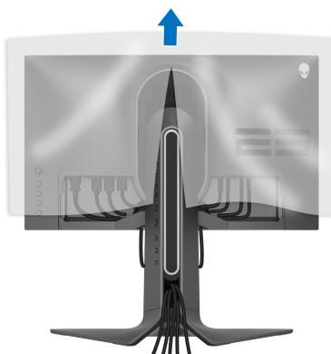
13. Inserire le linguette sul copri I/O nelle aperture sul coperchio posteriore dello schermo fino a fissarle in posizione.
