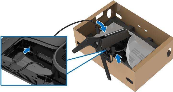
9. Indirizzare i cavi necessari, come il cavo USB upstream, i cavi USB downstream (opzionale, cavi non inclusi), cavi HDMI (opzionale, i cavi non sono inclusi) e cavo DisplayPort attraverso l'apertura per la gestione dei cavi sul supporto.
