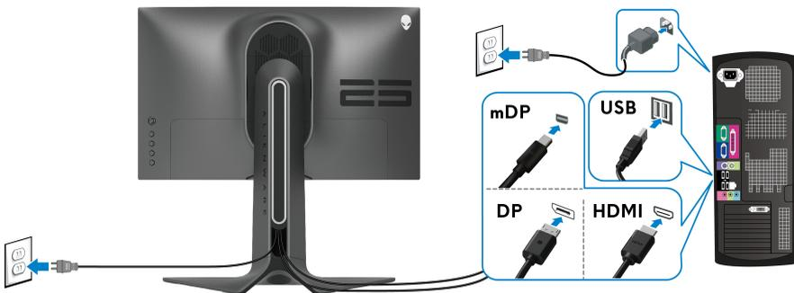
1. Collegare l'altra estremità del cavo DisplayPort (o da Mini-DisplayPort a DisplayPort) o HDMI connesso al computer.
