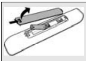
*Nota: Si las teclas de modo (TV o DVD/VCR) parpadean cuatro veces después de cada pulsación de tecla, el mando a distancia indica que la pila se está agotando. Cambie las pilas viejas por dos pilas nuevas tipo AAA.*
