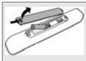
*Note: Nota: Se i tasti di modalità (TV o DVD/VCR) lampeggiano quattro volte dopo ogni volta che si preme un tasto, il telecomando indica che le batterie si stanno scaricando. Sostituite le batterie con due nuove del tipo AAA.*
