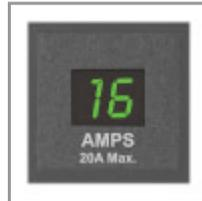
Die 1-Phasen PDU ermöglicht eine Strommessung in Echtzeit, um Stromkreisüberlasten zu vermeiden, die beim Anschluss zusätzlicher Geräte zu kostspieligen Ausfallzeiten führen könnten.
