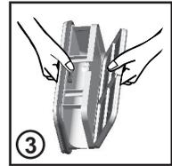
4. Entfernen Sie den Schaumgummifilter und reinigen Sie ihn unter fließendem Wasser, wobei Sie es drehen, um Flusen und Staub vollständig zu entfernen.
