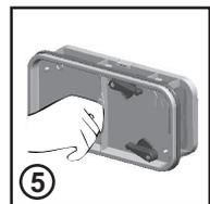
6. Setzen Sie die Wartungsklappe wieder ein.
