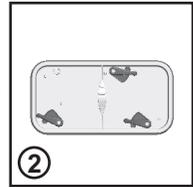
3. Nehmen Sie vorsichtig den Filterrahmen heraus und entfernen Sie etwaigen Staub oder Flusen vorsichtig mit einem Tuch. Reinigen Sie den Filter nicht mit Wasser.
