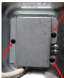
A tápkábel beszerelése után három csavarral csavarozza össze a fémfedelet.
