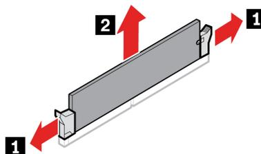
5. Eseguire la procedura di rimozione in senso inverso per reinstallare una nuova CRU.
