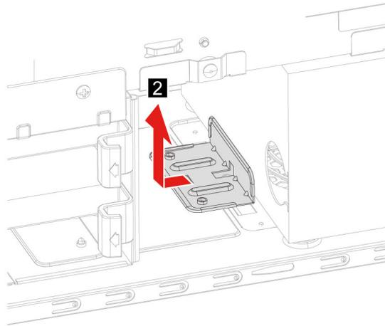
7. Rimuovere le viti di montaggio del gruppo di alimentazione dalla parte posteriore del case del computer.
