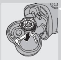
**3** Izvadite stare glave za brijanje iz jedinice za brijanje i stavite nove. Vratite okvir za pričvršćivanje u jedinicu za brijanje.
