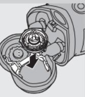
**3** Wyjmij głowice golące i włóż nowe do elementu golącego. Następnie załącz element zabezpieczający na element golący.
