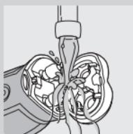
**2** Stiskněte uvolňovací tlačítko (1) a otevřete holící jednotku (2).
