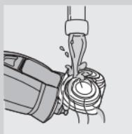
**3** Očistite jedinicu za brijanje i komoru za prikupljanje dlaka ispiranjem topлом vodom iz slavine.
