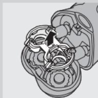
**1** Otvorte holiacu jednotku, potiahnite ju von z holiaceho strojčeka a vyberte prítlačný rám.
