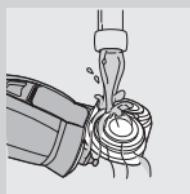
**3** Curățați unitatea de bărbierire și compartimentul de colectare a părului clătinând-le cu apă caldă de la robinet. Asigurați-vă că interiorul unității de bărbierire și compartimentul de colectare a părului au fost corect curățate.
