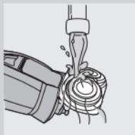
**3** Holiacu jednotku a komoru na chípky očistite opláchnutím pod prúdom horúcej vody.
