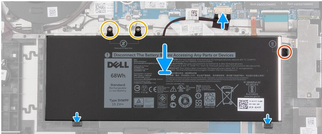
1. Insérez les languettes de la batterie dans les encoches situées sur l'assemblage repose-poignets et clavier.
