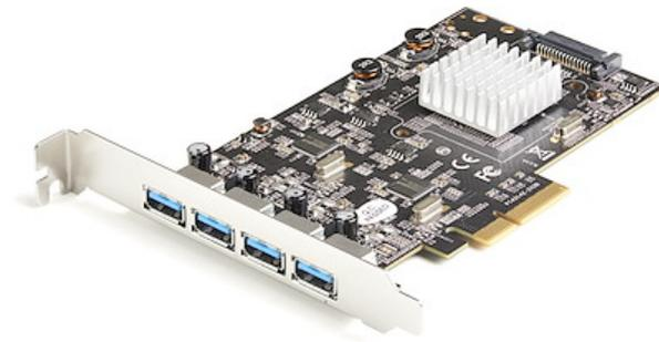
Esta tarjeta controladora PCIe USB 3.2 Gen 2 se instala en una ranura PCI-Express x4 disponible de su ordenador y le permite actualizar su sistema existente agregando cuatro puertos SuperSpeed USB-A (10Gbps). La tarjeta incluye dos controladores ASM3142 con hasta 20Gbps ancho de banda total, compartido entre los 4 puertos.
