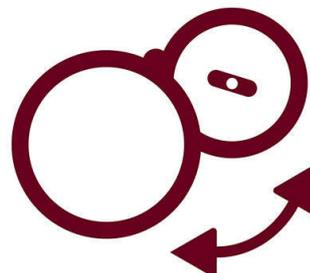
Il portafiltro si apre con uno spostamento laterale, caratteristica che semplifica il riempimento del caffè. Il portafiltro è anche rimovibile, per una facile pulizia.
