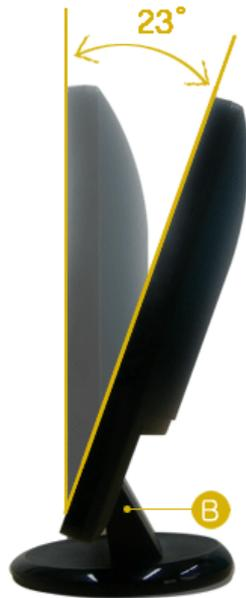
※ (B), permet de régler l'angle d'inclinaison de 0° à 23° vers l'arrière pour obtenir l'angle de vision le plus confortable.
