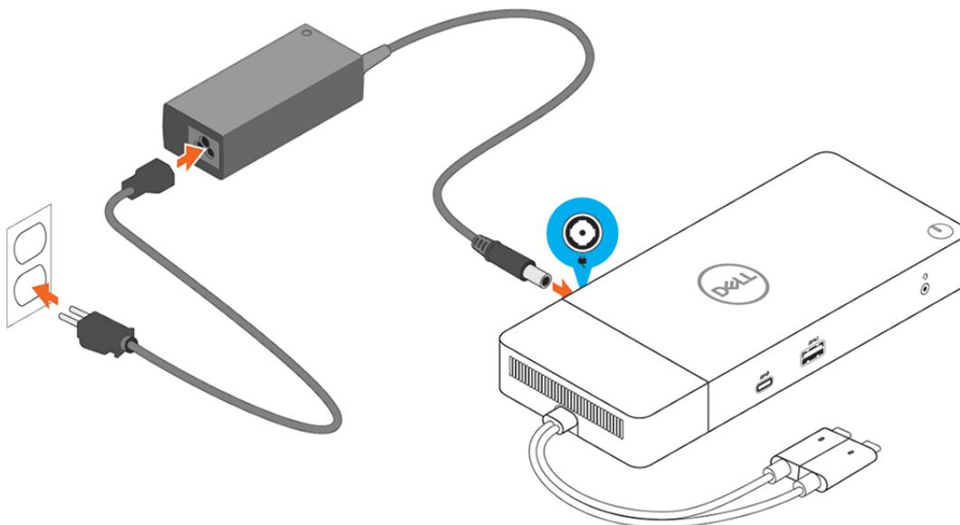
**Abbildung 6. Netzadapter anschließen**
