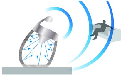
Il rivestimento posteriore ricurvo dalle linee ricercate di questo sistema docking per altoparlanti crea una struttura acustica efficace per una riproduzione sonora ottimale. Le curve semplici rafforzano la rigidità della cassa degli altoparlanti riducendo in maniera sensibile la risonanza interna ed eliminando le vibrazioni e la distorsione audio. Potrai così ascoltare un audio cristallino con degli altoparlanti dal look mozzafiato.
