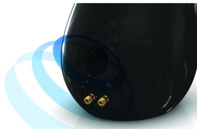
Il carico acustico bass-reflex utilizza un bass pipe sintonizzato sul volume acustico della cassa altoparlante per riprodurre bassi profondi da strutture compatte. Il bass-pipe appositamente progettato aiuta il flusso d'aria e genera bassi profondi e potenti, anche ad alto volume, e riduce al minimo la turbolenza dell'aria che potrebbe causare deformazione.
