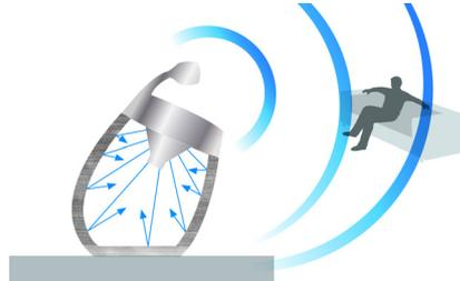
La cuidadosamente diseñada cubierta posterior curvada de este parlante con base Philips crea una estructura acústica altamente efectiva para la reproducción del sonido. Su curva definida refuerza la rigidez de la carcasa del parlante, lo que reduce de forma espectacular la resonancia interna y elimina la vibración y la distorsión del sonido. De esta forma podés disfrutar de un sonido increíblemente nítido en unos parlantes de diseño sorprendente.
