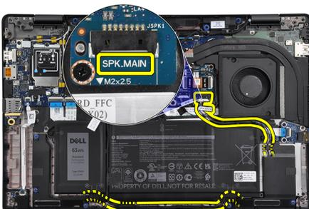
Verbinden Sie das Hauptlautsprecherkabel mit dem **SPK.MAIN**-Anschluss auf der Lautsprecherplatine und führen Sie das Lautsprecherkabel über das Hochtoner-Kabel.
