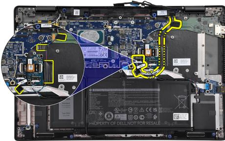
4. Verbinden Sie die Bildschirm-, Kamera-, Touchscreen- und Sensorplatinen-Kabel mit der Hauptplatine.
