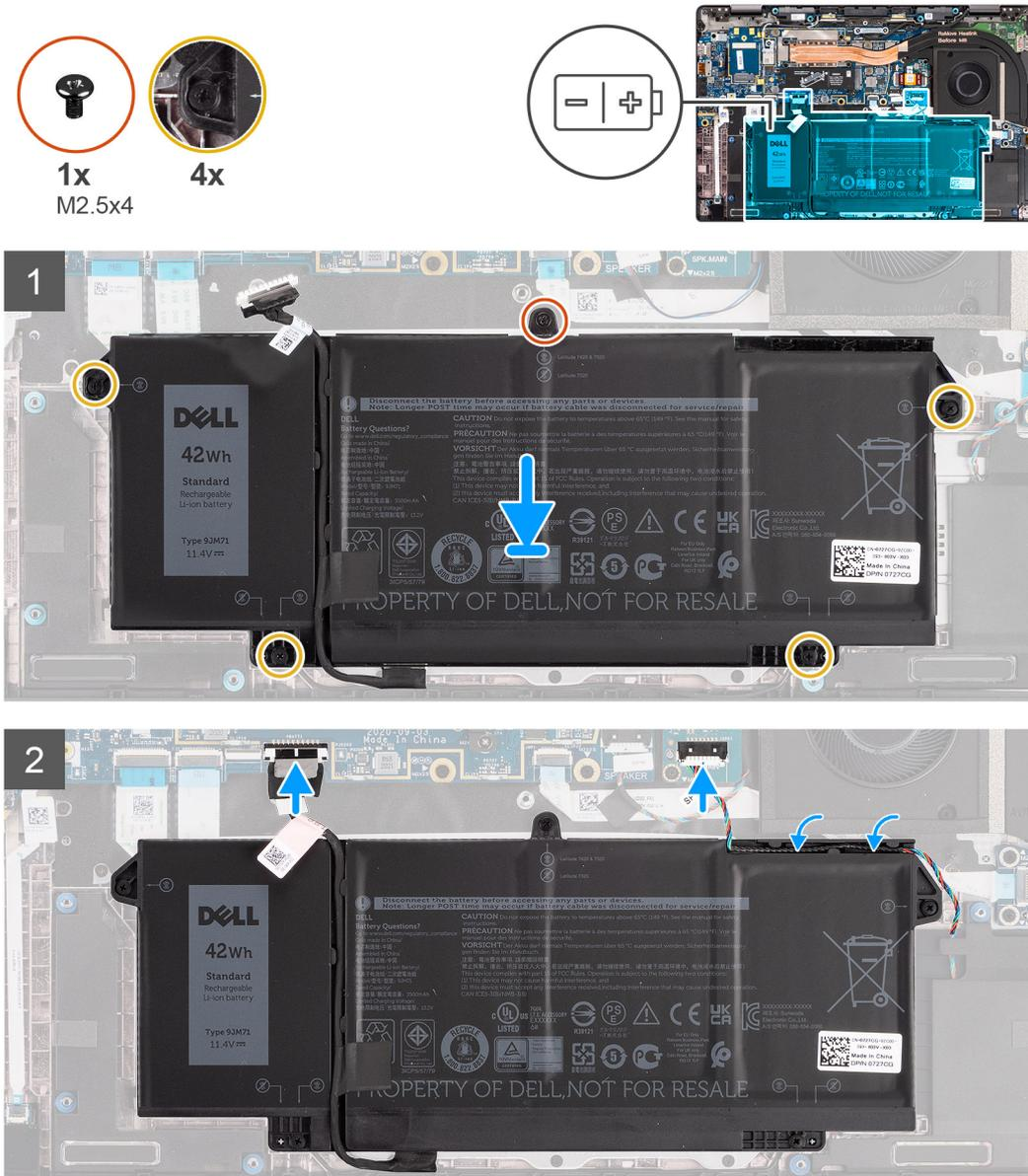
**ANMERKUNG:** Wenn der Akku von der Systemplatine getrennt ist, tritt beim Starten des Computers eine Verzögerung auf, da der Computer einen RTC-Reset durchläuft.
