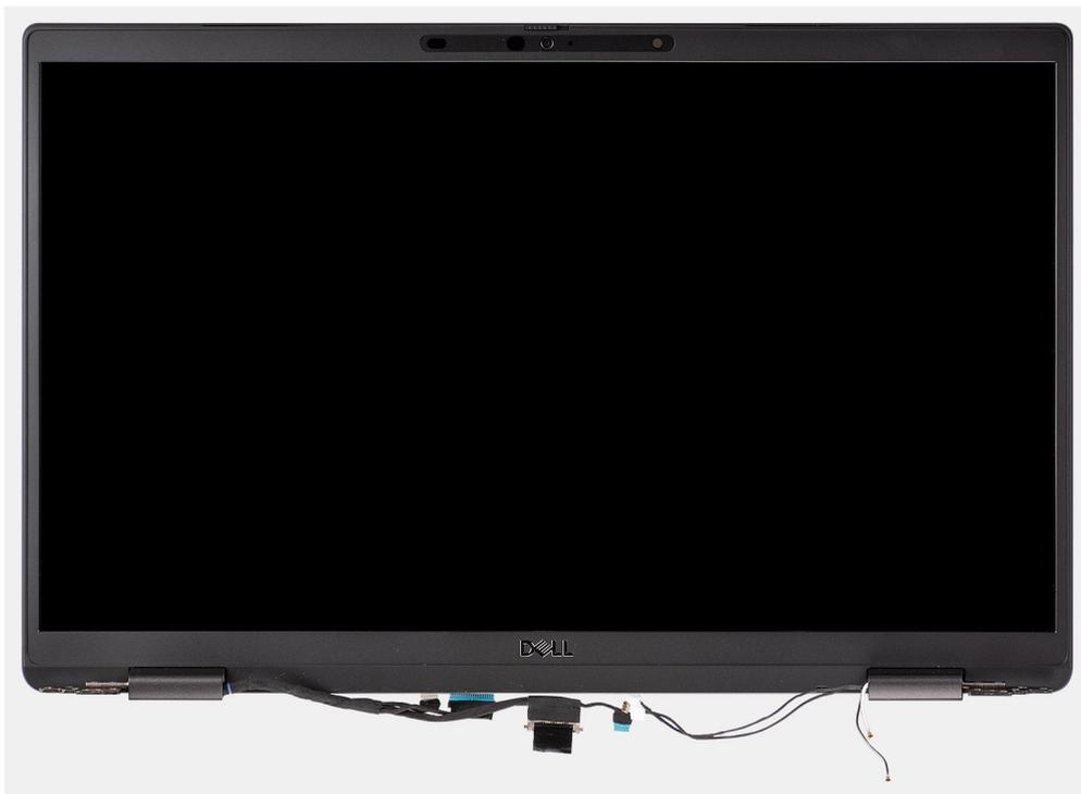
Abbildung 5. Bildschirmbaugruppe mit WLAN- und WWAN-Antennenkabeln
