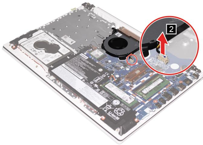
Figure 17. Disconnect the fan cables
