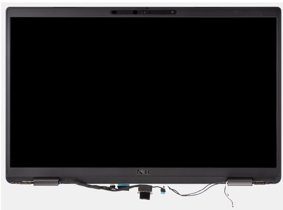
איור 5. מכלול הצג עם כבלי אנטנת WLAN ו-WWAN
