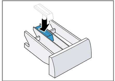
6. Die Öffnung für die Waschmittelschublade reinigen.
