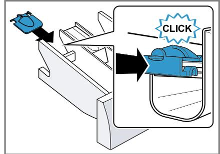
4. Die Waschmittelschublade einsetzen.
