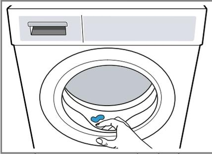
3. Die Tür und die Waschmittelschublade offen lassen, damit Restwasser abtrocknen kann.
