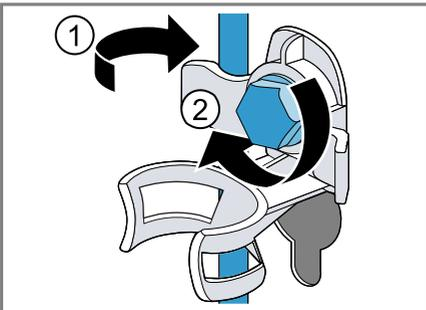
5. Den Schlauch in die Halterung einsetzen.
