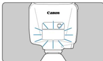
Wenn die automatische Scharfstellung des Motivs aufgrund schlechter Lichtverhältnisse oder bei Sucheraufnahmen mit geringem Kontrast schwierig ist, blitzt das integrierte Infrarot-AF-Hilfslicht automatisch, um den Autofokus zu unterstützen.
