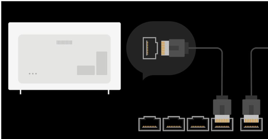
01 Collegare la porta LAN del TV e il router utilizzando un cavo LAN.
