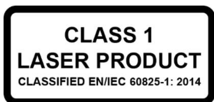
Questo dispositivo è classificato come prodotto laser di classe 1 per EN/IEC 60825-1:2014. Questo dispositivo è conforme agli standard sulle prestazioni FDA per i prodotti laser, fatta eccezione per la conformità a IEC 60825-1 Ed.. 3, come descritto in Avviso laser n. 56, dell'8 maggio 2019.
