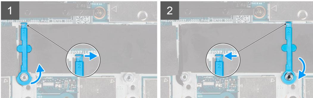
La figura fornisce una rappresentazione visiva se si sta sostituendo un'unità SSD M.2 2230 con un'unità SSD M.2 2280.
