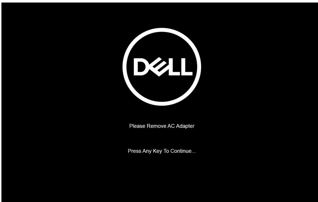
Una volta che il sistema si arresta, è possibile eseguire le procedure di sostituzione senza scollegare il cavo della batteria dalla scheda di sistema.
