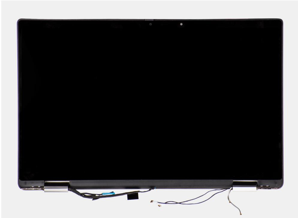
Abbildung 1. Bildschirmbaugruppe mit Antennenkabeln
