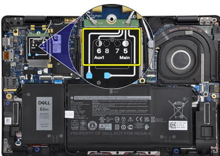
2. Lösen Sie die Schraube (M2x2.5) und entfernen Sie die WWAN-Kartenhalterung.
