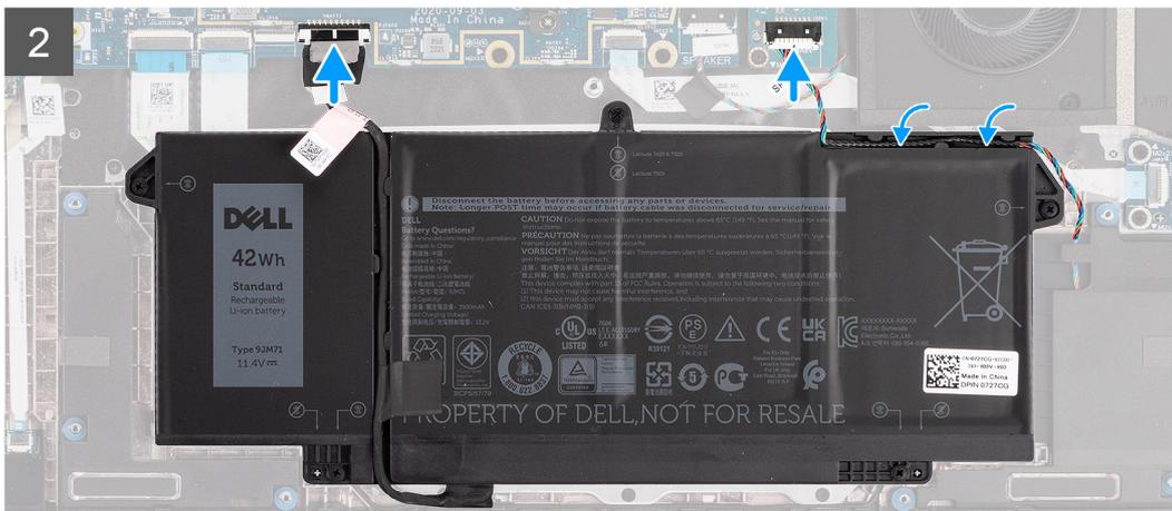
**ANMERKUNG:** Wenn der Akku von der Systemplatine getrennt ist, tritt beim Starten des Computers eine Verzögerung auf, da der Computer einen RTC-Reset durchläuft.
