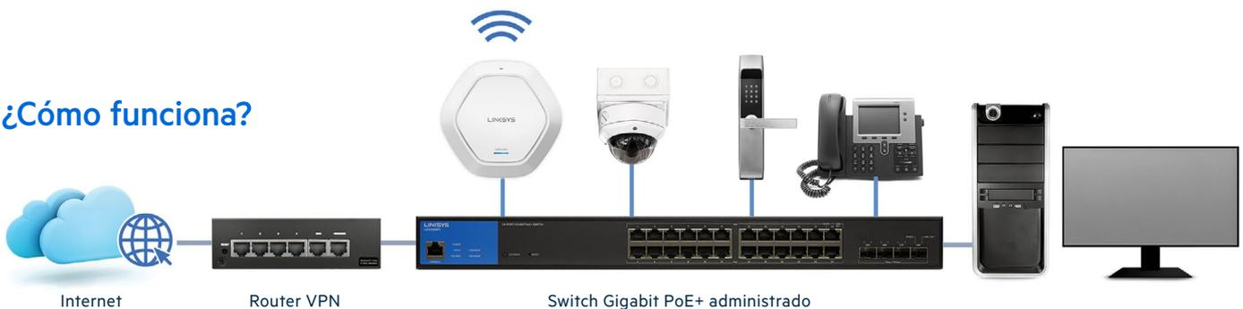
Los switches administrados PoE+ de Linksys pueden suministrar electricidad a aquellos dispositivos que estén habilitados con la función PoE+, como por ejemplo cámaras de seguridad, puntos de acceso, sistemas de control de acceso de puertas, teléfonos VoIP y sistemas ProAV. Esto eliminará la necesidad de usar enchufes y cables de corriente adicionales, facilitando y abaratando las instalaciones.
