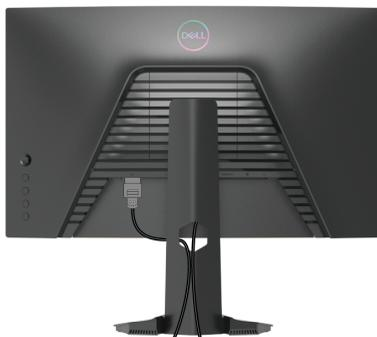
Depois de anexar todos os cabos necessários ao seu monitor e computador, (Veja [Conectando seu monitor](#) para anexar um cabo,) utilize o slot de gerenciamento de cabos para organizar todos os cabos como mostrado acima.
