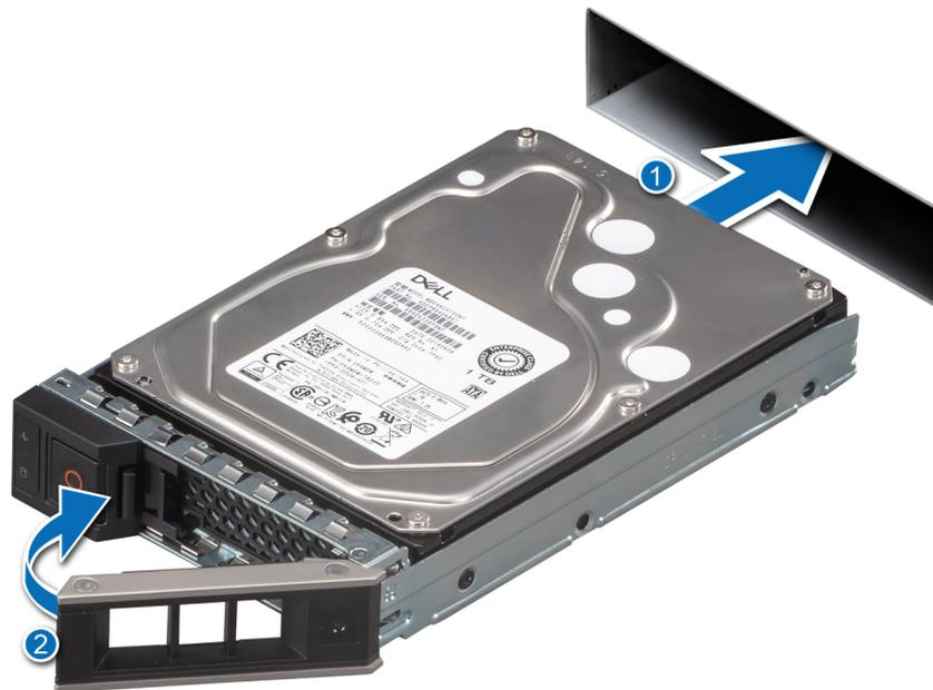
**Ilustración 22. Instalación de la unidad de intercambio activo**
