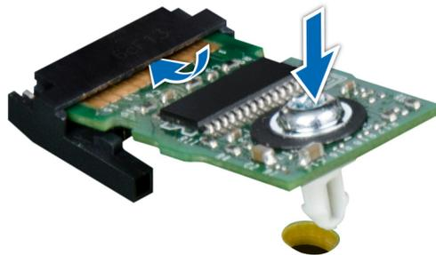
Ilustración 74. Instalación del TPM
