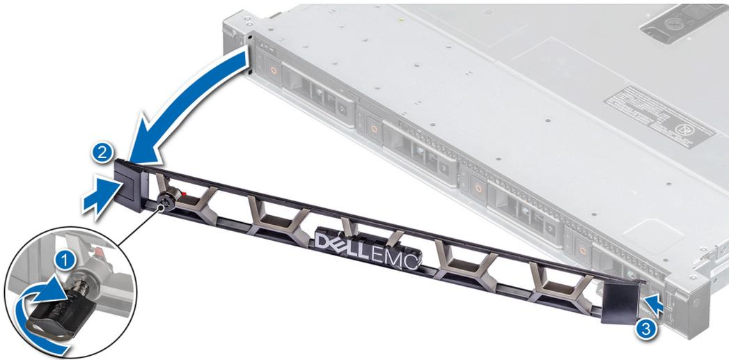
**Ilustración 9. Extracción del bisel frontal**
