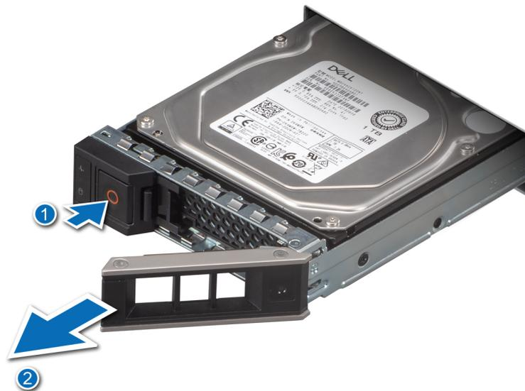
Abbildung 21. Entfernen eines Hot-Swap-fähigen Laufwerks
