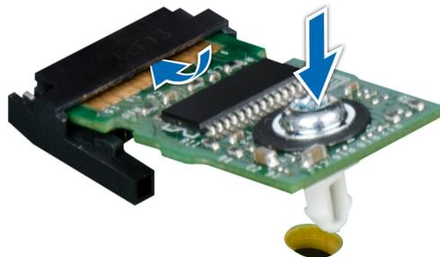
Abbildung 74. Installieren des TPM-Moduls
