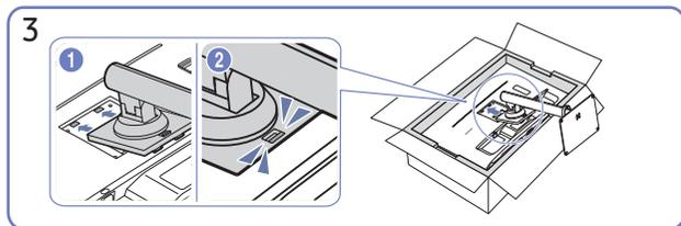
3 Poussez le support assemblé dans le corps principal dans le sens de la flèche, comme indiqué sur la figure.
