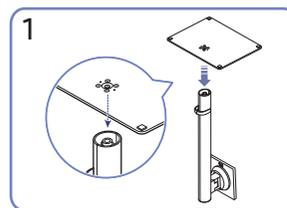
1 Placez la base du support sur le tube du support dans la direction indiquée dans l'illustration. Vérifiez que le tube du support est bien raccordé.
