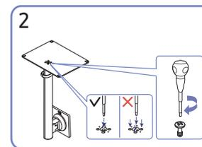
2 Serrez la vis sur la partie inférieure de la base du support. Fixez la grande vis au milieu pour l'assemblage.
