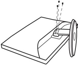
2. Lösen Sie die drei Schrauben, nehmen Sie die Basis anschließend vom Monitor ab.
