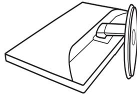
2. Drücken Sie zum Entfernen der Basis von der Basissäule die Freigabeclips zusammen.
