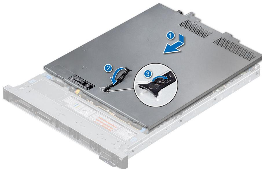
Figure 18. Installation du capot du système
