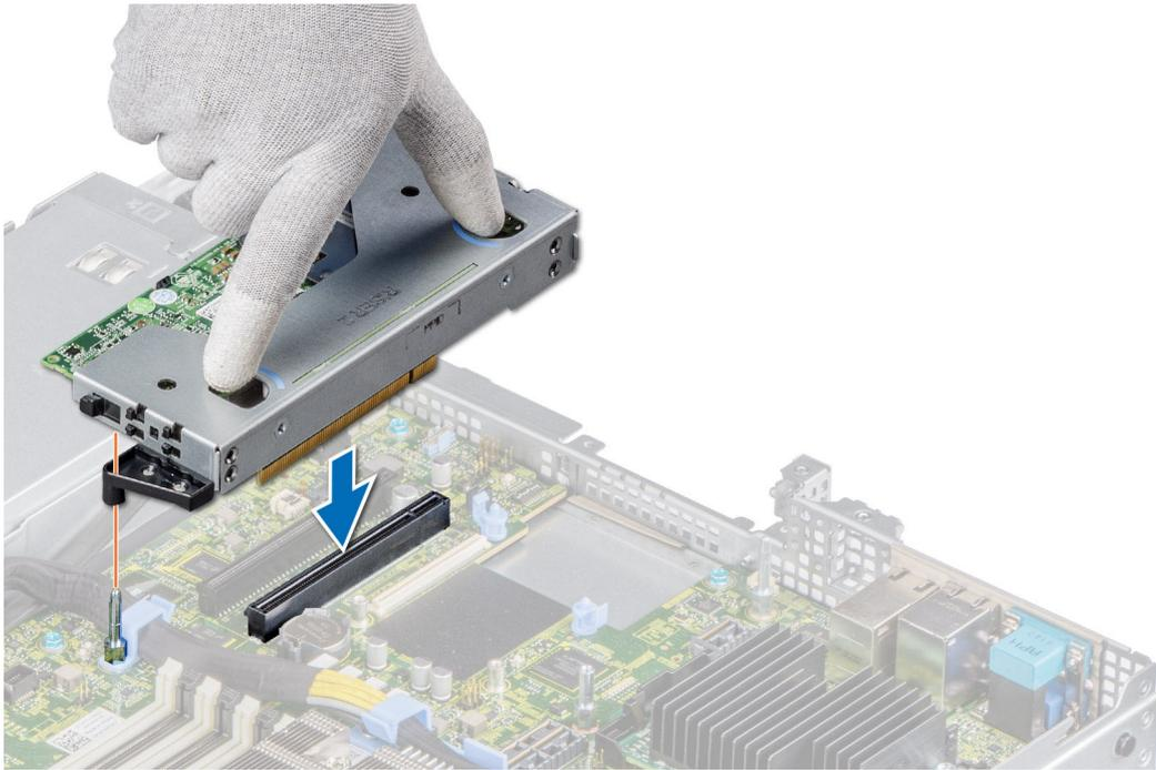
Figure 56. Installation de la carte de montage mi-hauteur gauche
