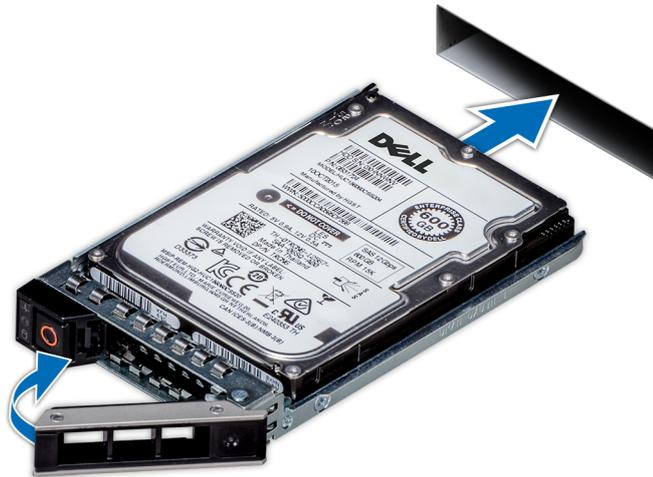
Figure 30. Installation d'un support de disque
