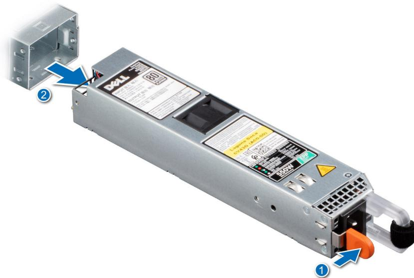
Figure 93. Retrait d'un bloc d'alimentation
