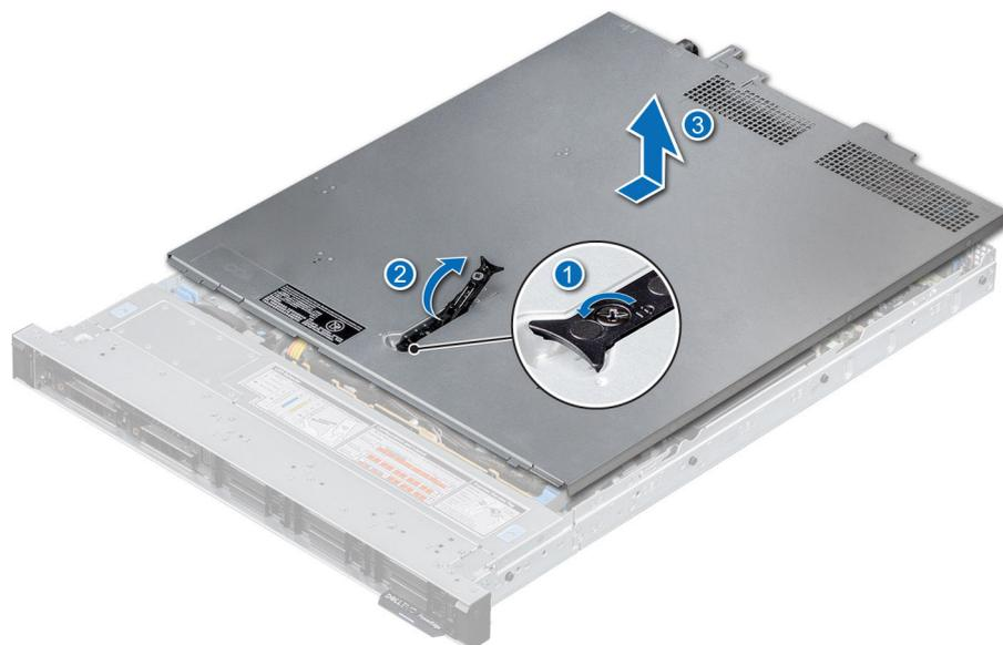
Figure 17. Retrait du capot du système
