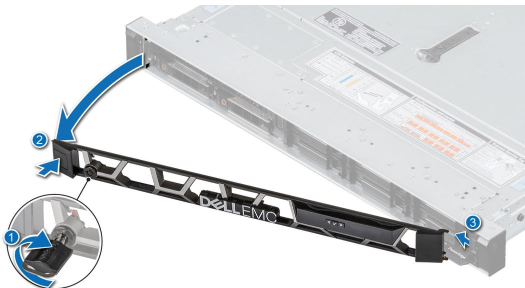
Figure 15. Retrait du panneau avant avec l'écran LCD
