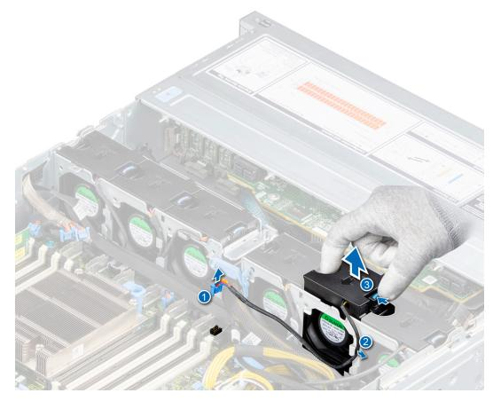
Figure 27. Removing a fan
