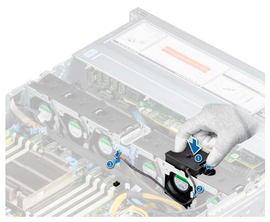
Figure 29. Installing a fan
