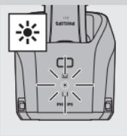
*Remarque : Si vous appuyez sur le bouton marche/arrêt du système Jet Clean pendant le programme de nettoyage, le programme est arrêté, puis remis à zéro. Le cas échéant, le voyant de nettoyage ou de séchage s'arrête de clignoter et le support reprend sa position initiale.*
