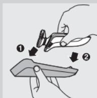
**4** Inserite per prima la parte superiore del rasoio nello spinotto di ricarica (1), quindi premete la parte inferiore nello spinotto (2).
