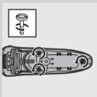
**7** Desaperte os 3 parafusos na parte interior da máquina de barbear e retire a tampa traseira.
