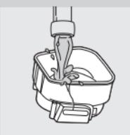
**4** Remplissez la cuve de liquide de nettoyage HQ200 jusqu'au niveau maximal (MAX).
