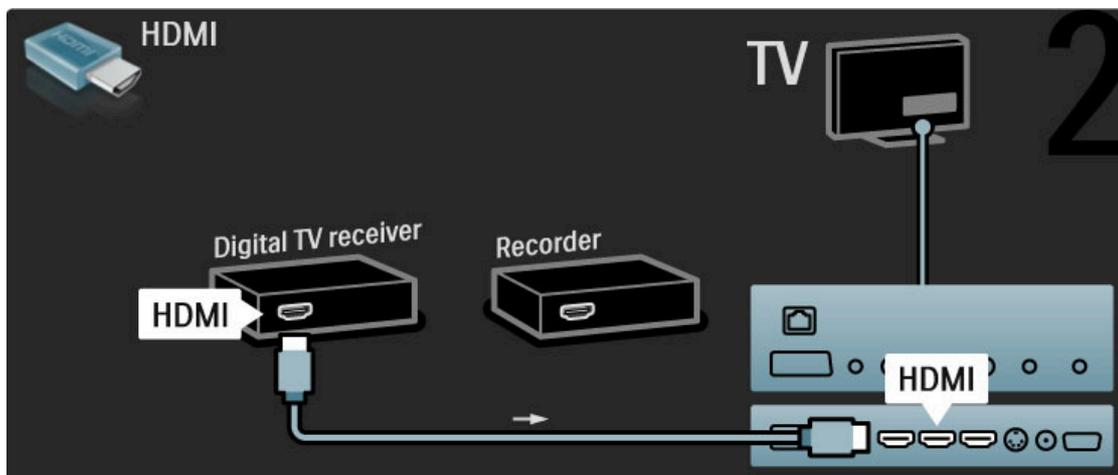
Verbinden Sie schließlich den Disc-Recorder über ein HDMI-Kabel mit dem Fernseher.
