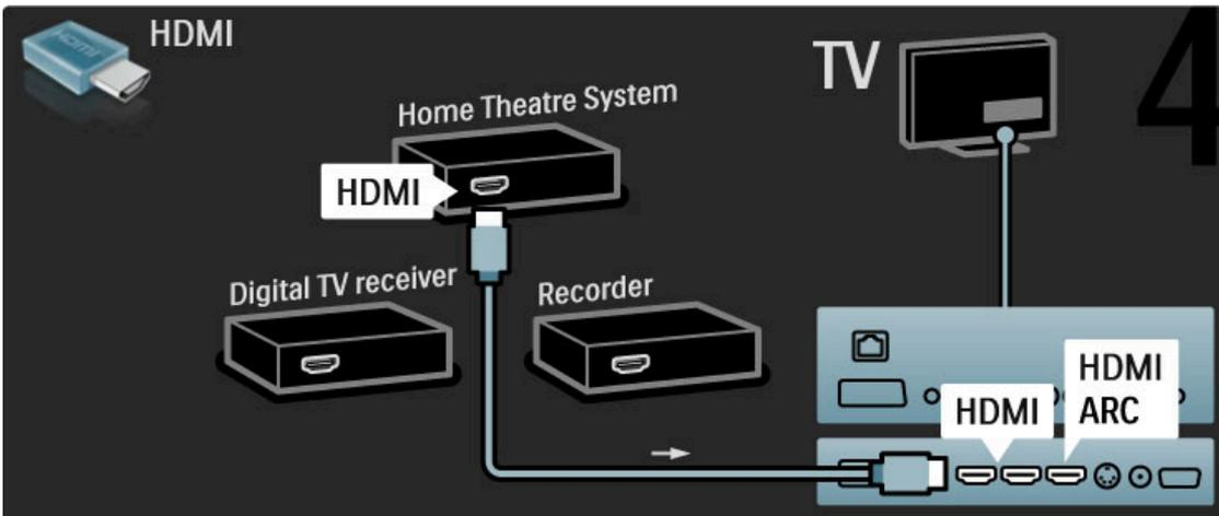
Wenn Sie die HDMI-ARC-Anschlüsse am Fernseher und am Gerät nicht nutzen, fügen Sie ein digitales Audiokabel hinzu (Cinch/Koaxial).
