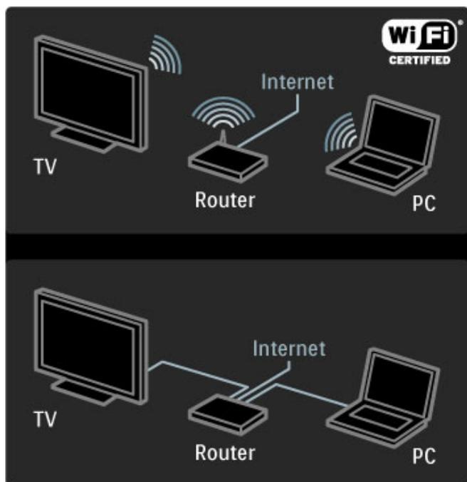
Wenn Sie eine kabelgebundene Verbindung zum Router herstellen möchten, benötigen Sie ein Netzwerkkabel (Ethernet).
