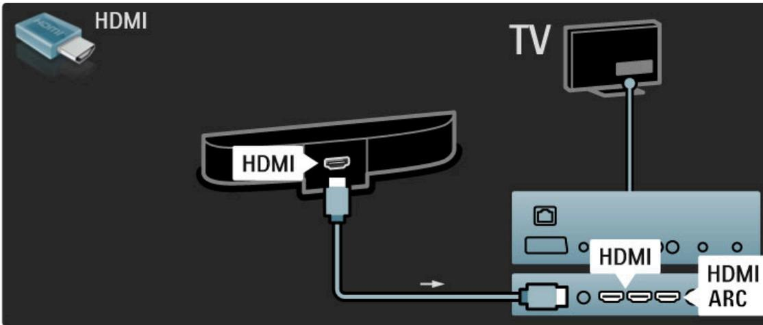
Wenn Sie die HDMI-ARC-Anschlüsse sowohl am Fernseher als auch am Gerät verwenden, benötigen Sie kein weiteres Kabel. Falls nicht, lesen Sie weiter.
