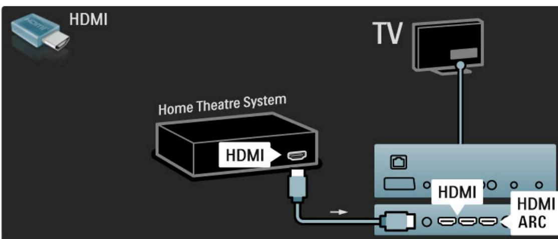
Wenn Sie die HDMI-ARC-Verbindung nicht nutzen, fügen Sie ein digitales Audiokabel hinzu (Cinch/Koaxial).
