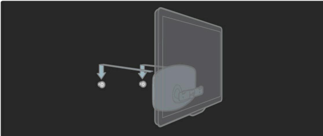
Um das Fernsehgerät waagrecht auszurichten, ziehen Sie den unteren Bereich des Fernsehgeräts leicht in Ihre Richtung, und lassen Sie es auf den Scheiben gleiten.
