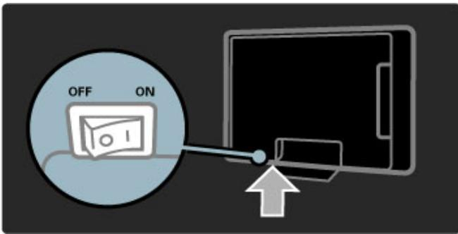
Wenn die rote Standby-Leuchte aus ist, schalten Sie den Fernseher mit dem Netzschalter des Fernsehers ein.
