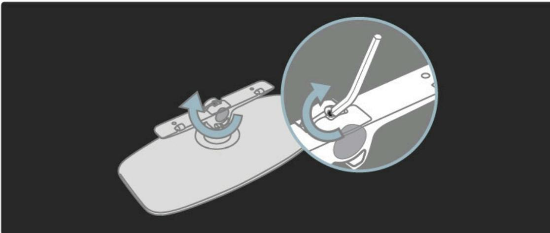
Befestigen Sie den Standfuß am Fernsehgerät.
