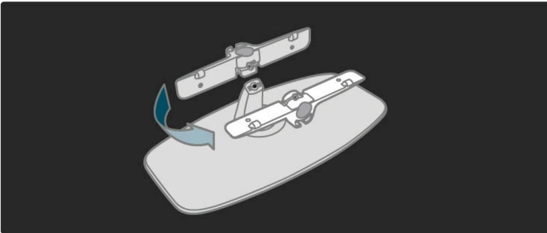
Positionieren Sie die Leiste erneut auf der Halterung und befestigen Sie den Bolzen mit dem Innensechskantschlüssel.
