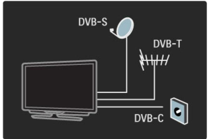
Abgesehen von den Empfangsmethoden DVB-T und DVB-C verfügt dieser Fernseher auch über einen eingebauten DVB-S/S2-Satellitenreceiver. Sie können eine Satellitenschüssel anschließen und **digitale Satellitensender** empfangen.
